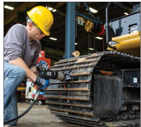
▼ Chaves de Torque Pneumáticas da Série PTW são ideais para aplicações onde velocidade e precisão são críticas, tais como na manutenção de esteiras.
