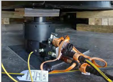
◀ Cilindros customizados de dupla ação com porca trava e sensores internos de curso e uma válvula embutida para sustentação de carga durante o levantamento de componentes nucleares.
