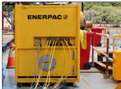
▼ Um sistema "SyncHoist" é usado para alinhar blocos de aço das secções da torre de controle de um navio, permitindo o levantamento e o posicionamento graduais da carga.
