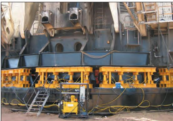
◀ Para evitar pressão de retorno e aumentar a velocidade de retorno do cilindro ao utilizar mangueiras longas, a linha de mangueiras Enerpac HC-7300 com maior diâmetro interno é a melhor escolha.
