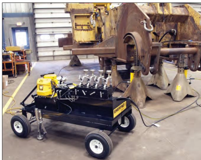
◀ O Sistema de Levantamento Nivelado forneceu uma solução segura e rápida durante a reconstrução de um veículo fora-de-estrada.
