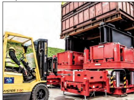
▼ Um sistema "SyncHoist" é usado para alinhar blocos de aço das seções da torre de controle de um navio, permitindo o levantamento e o posicionamento graduais da carga.
