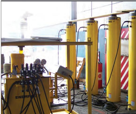
▲ *Cilindros customizados de 500 tons. e curso de 183 cm. para o cabo elétrico das pás de escavadeiras.*
