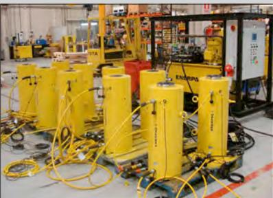
◀ Cilindros customizados com sensores embutidos para construção de ponte.
