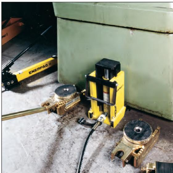
▼ Tanque para transporte de químicos: na(s) primeira(s) polegada(s) a carga foi levantada com um cilindro compacto da Série RCS e depois movimentada pelos conjuntos de roletes de carga para o transporte.
